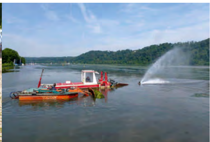
Bild 5.23: Testeinsatz eines Hydroventuri-Boots, um mittels Wasserstrahl Wasserpflanzenbestände unter Wasser mit Wurzeln aus dem Sediment vollständig herauszulösen
