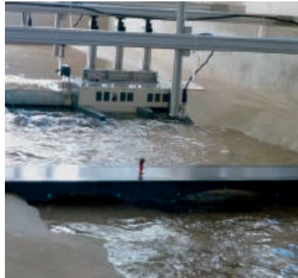
Im Modell wurden das Kraftwerk am Ausgleichsweiherr, der Möhnebach und die Brüningser Brücke nachgebildet.
