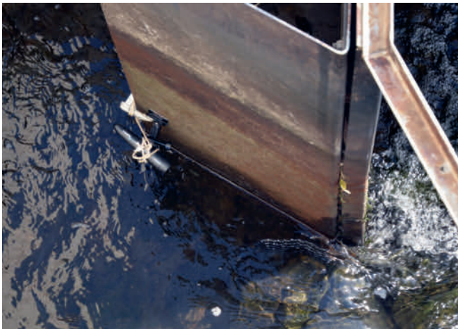
Bild 18.14: Unterwasserkamera am Leitblech Fig. 18.14: Underwater camera at the guide plate
