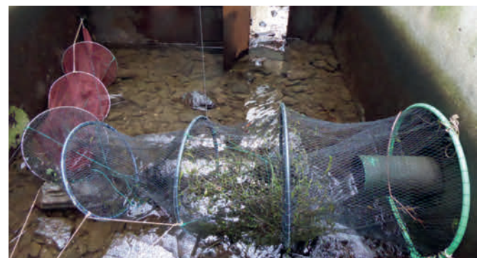
Bild 18.12: Reuse am Auslauf des Aalfluchtrohrs Fig. 18.12: Fish trap at the outlet of the escape pipe for eels
