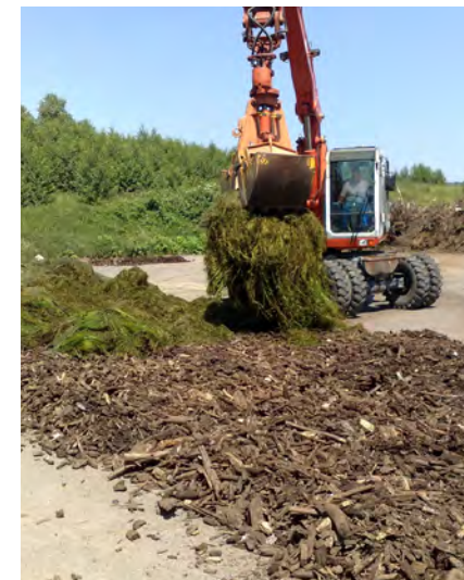
Bild 15: Vorbereitung zur Kompostierung von Elodea : Strukturmaterial (zerkleinertes Treibholz) wird mit gemähtem Elodea -Material durchmischt und zur Kompostierung zu Mieten aufgesetzt
