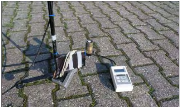
Abb.6.2-8: Li-COR Quantensensor LI-189: Messgerät und Sensor mit Gestänge zur vertikalen Messung der eingestrahlichten Lichtintensität.
