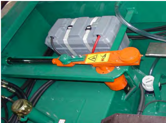
Abb. 6.12-10: links hydraulischer Antrieb der Sense, rechts Schleppsensenstößel mit Kette
