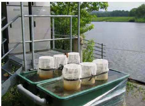
Abb. 6.7-2: Aufbau Röhren und „Schaukel“ von R1 bestückt mit 2 Pflanzen E. nuttallii
