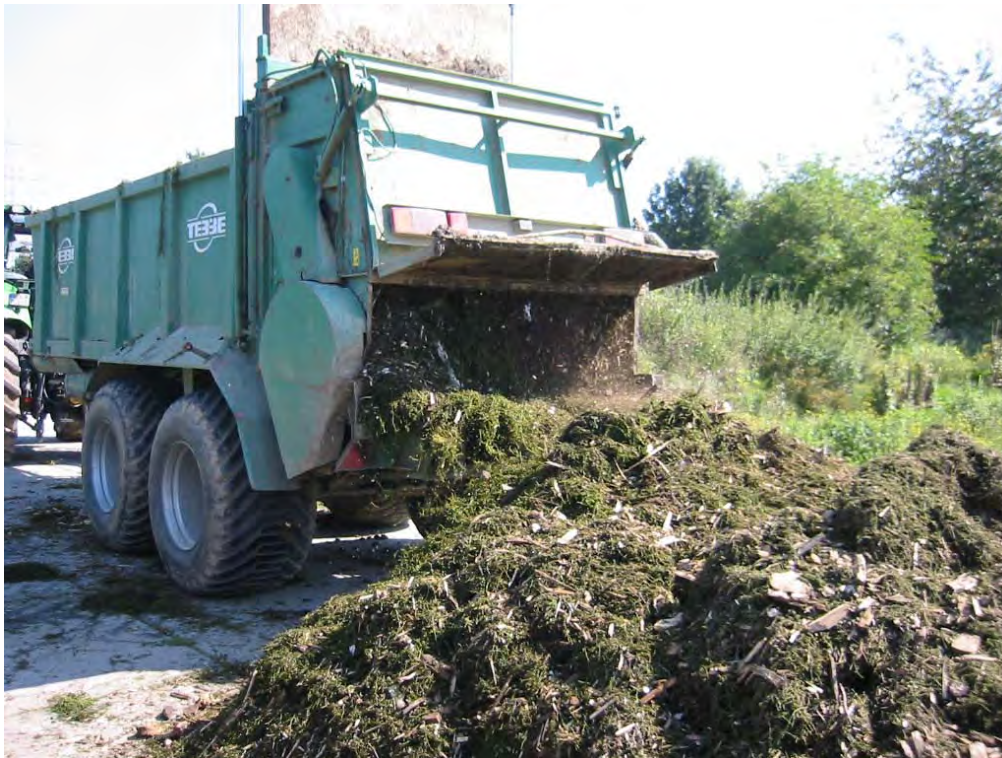
Abb. 6.13-4: Eingesetzte Mischtechnik, modifizierter mobiler Klärschlammstreuer Fabr. TEBBE
