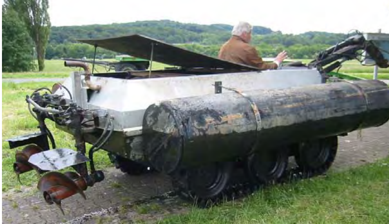
Abb. 6.12-5: Sturm-Boot mit Turbulenzen erzeugenden Wellen am Heck
