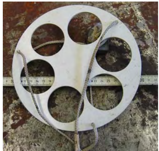
Abb. 6.2-11: Modifizierte Secchi-Scheibe zur Bestimmung der Sichttiefe
