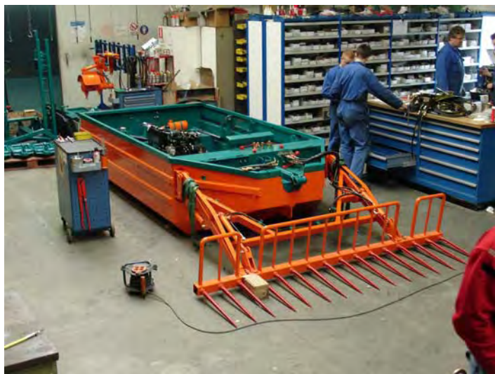
Abb. 6.12-8: links: Mähboot mit T-Mähwerk, rechts: Mähboot mit Schubrahmen zur Aufnahme von Wasserpflanzen
