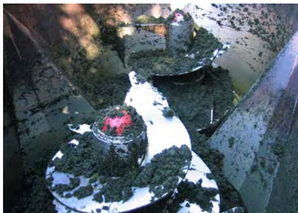
Abb. 6.14-5: Futtermischwagen mit vertikalen Schneidmischschnecken
