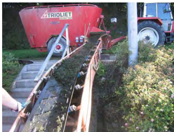
Abb. 6.14-6: Futtermischwagen mit Gurtbandförderer zum Elodea -Austrag
