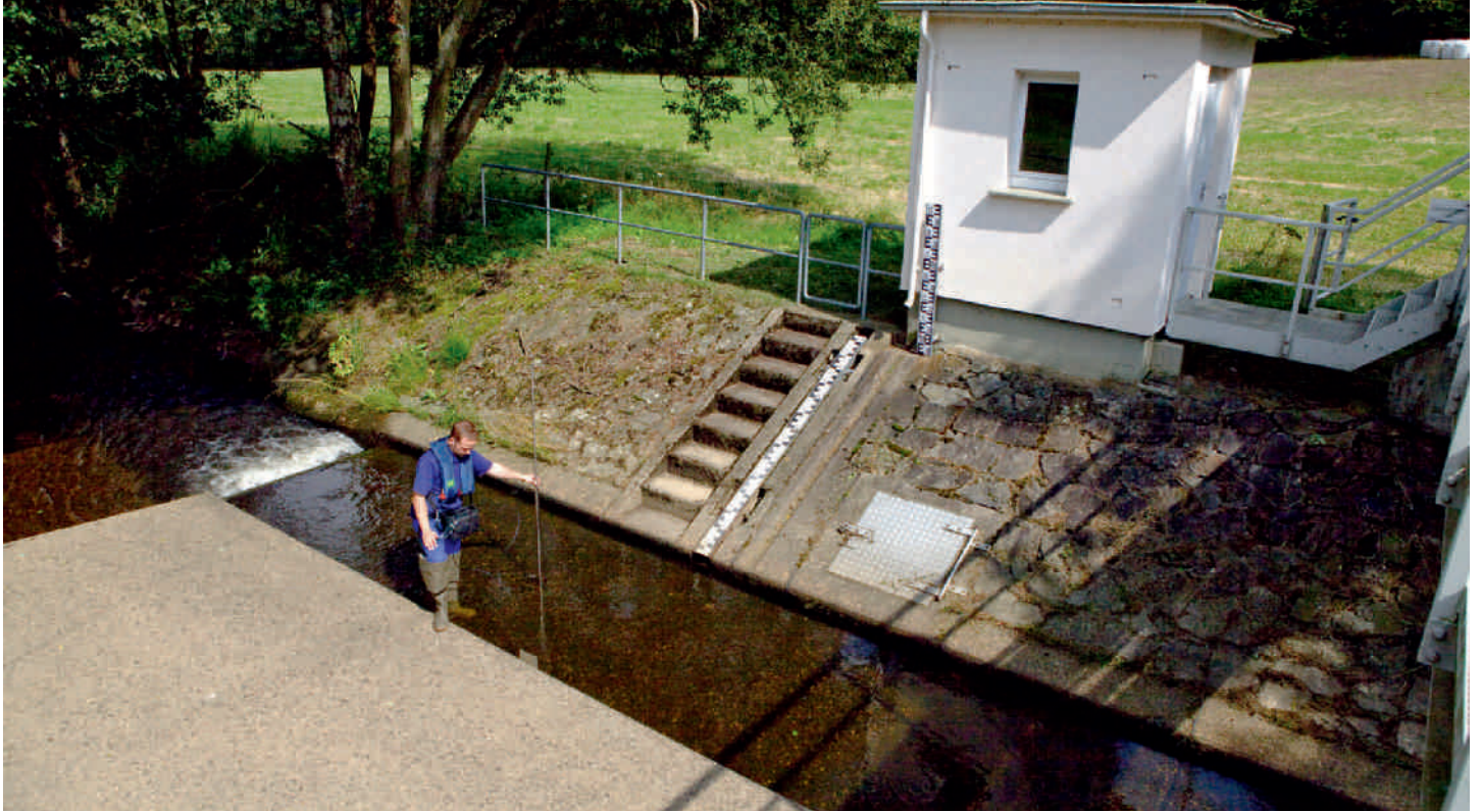
Nahezu 50 Pegelanlagen im Ruhreinzugsgebiet zeichnen rund um die Uhr den aktuellen Wasserstand auf. Nearly 50 gauging stations in the Ruhr catchment area record the actual water levels round the clock.
