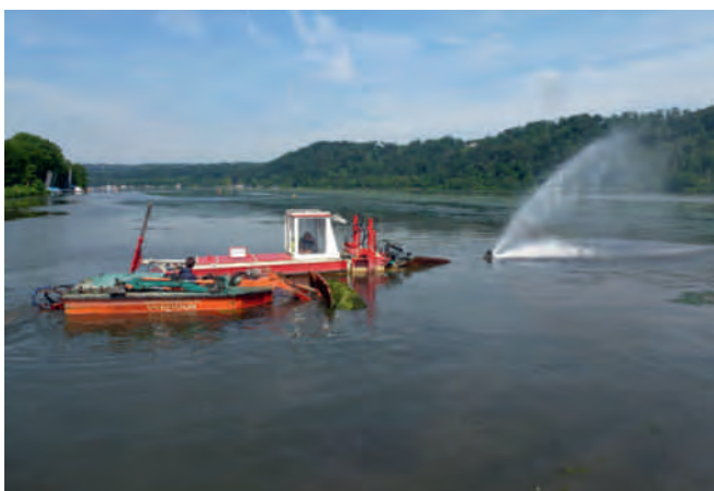
Bild 5.22: Hydroventuriboot aus den Niederlanden, das mittels Wasserstrahl Wasserpflanzen inklusive ihrer Wurzeln aus den Sedimenten herausspülen kann, im testweisen Einsatz im Jahr 2016 im Baldeneysee.
