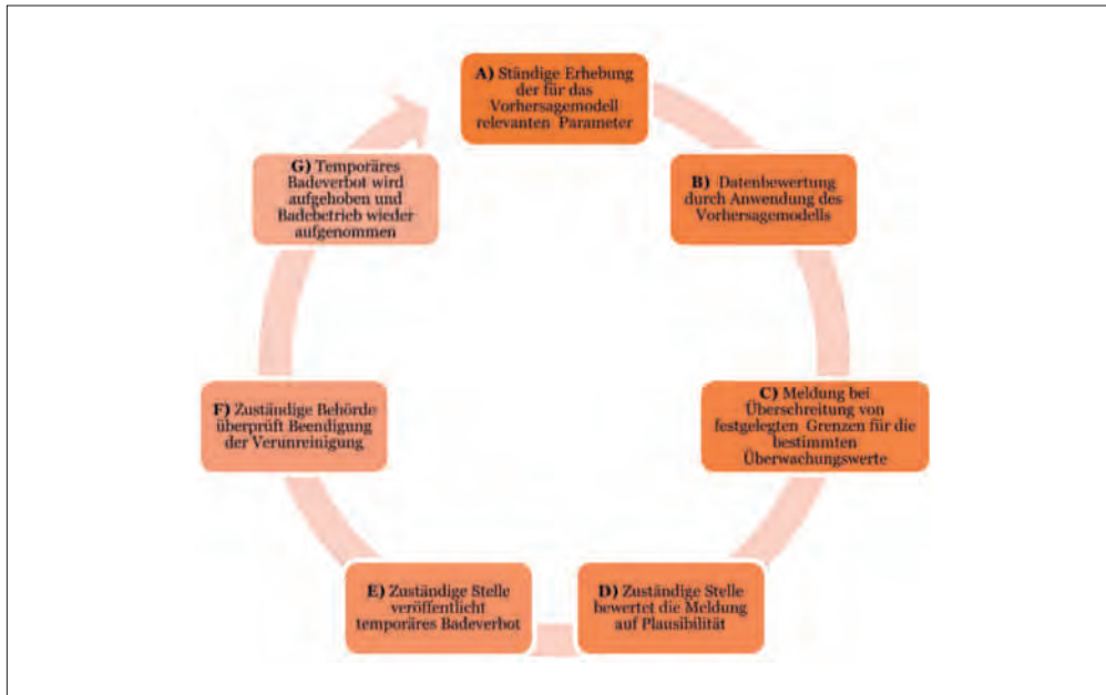
Bild 9.5: Prozessablauf des Frühwarnsystems, Quelle: [9.5] Fig. 9.5: Process operation of the early warning system, source: [9.5]
