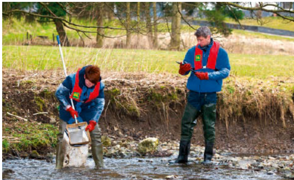
Hydrobiologische Probenahme zur Bestimmung der Gewässerqualität.
