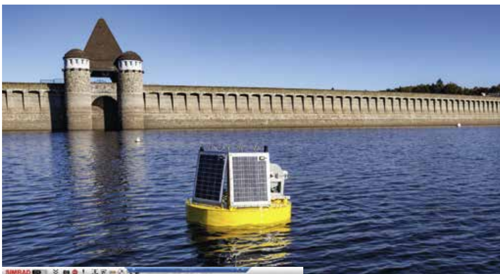
Die Profilerboje auf der Möhnetalsperre wird über Solarmodule autark mit Strom versorgt. Sie liefert unter anderem Sonarbilder wie dieses, das einen Fischschwarm zeigt. Der Großteil der Fische (blaue Pünktchen zwischen ca. 14 und 26 Metern Tiefe) hält sich unterhalb des sauerstofffreien Riegels auf.
